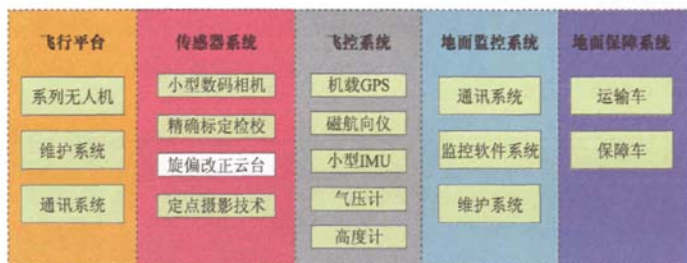
图1 无人机测绘遥感系统组成图
